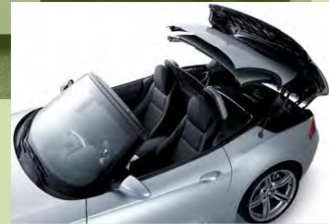
**20 Sekunden zur Freiheit:** 2-teiliges Webasto Retractable-Hardtop in Aluminium-Schalen-Bauweise für den BMW Z4.
