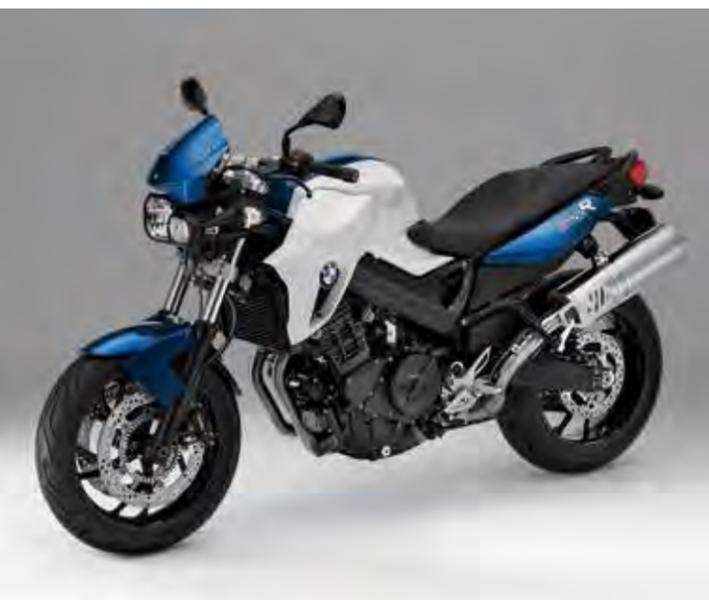
**BMW F 800 R** Das kleine, sexy Naked Bike mit hohem Fun-Faktor. Der Zweizylinder mit 798 Kubik pustet 87 PS raus und macht mit 86 Nm Drehmoment mächtig Druck. Mit dem knackigen, aber extrem stabilen Fahrwerk sowohl für schnelle Routiniers als auch für Newcomer leicht zu bändigen.
